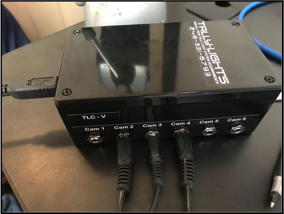
Controlador de luces Tally y luces Tally conectadas con 3,5 mm cables.
