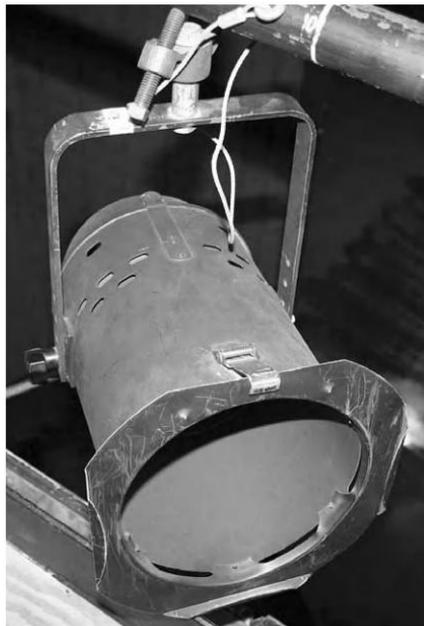
Un faro antiguo. Estas lámparas Vienen en puntos anchos, medianos y estrechos. configuraciones. Obviamente una lámpara ancha dispersa la luz al máximo, mientras que un estrecho El punto dispersa menos la luz.
