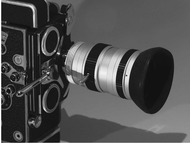
FIGURA 4-3 El objetivo zoom. Fíjate en las tapas de la torreta donde estarían otros objetivos fijos. Con el objetivo zoom no las necesitamos.
