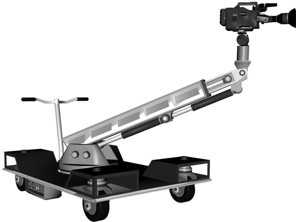
FIGURA 2-4 Un dolly con soporte neumático para subir y bajar la cámara.
