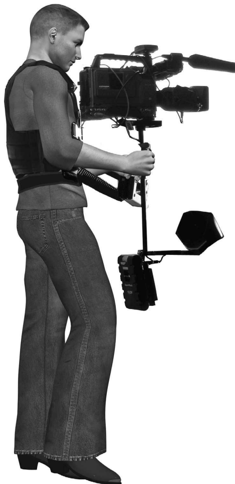
FIGURA 2-6 Los equipos de estabilización de cámara cubren la brecha entre las tomas estáticas con trípode y las técnicas manuales en movimiento.
