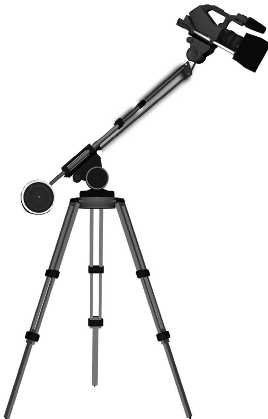
FIGURA 2-5 Un brazo articulado es útil para tomas desde ángulos altos y con grúa.
