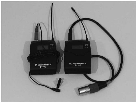
FIGURA 5-5 Micrófono de solapa y receptor inalámbricos
