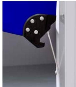
*En caso de colisión, el borde del cierre se puede doblar en todas direcciones. Las cuerdas pre-tensadas garantizan una deformación controlada hasta que las conexiones entre el final de la puerta y las piezas guías se separan. Consecuentemente el tejido de la puerta puede deslizarse fuera de las guías del marco en cualquier dirección.*
