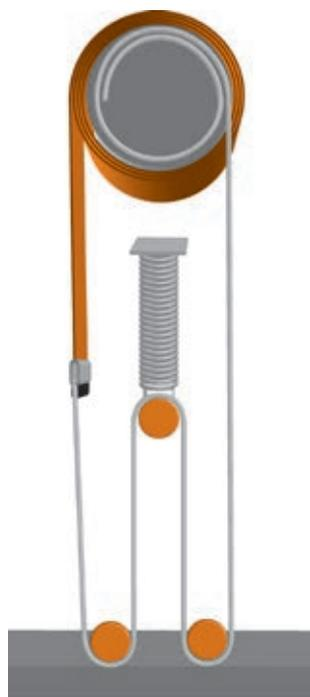
*El sistema de resistencia al viento de EFAFLEX mantiene constantemente tensa la hoja de la puerta. Ideal donde el viento o las corrientes de aire negativas producen tensión!*
