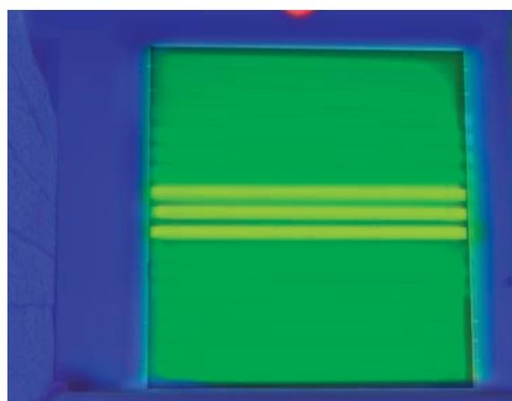
Las lamas aisladas térmicamente EFA-THERM® de la EFA-SST® mejoran considerablemente el aislamiento térmico, reduciendo así los costes energéticos.
