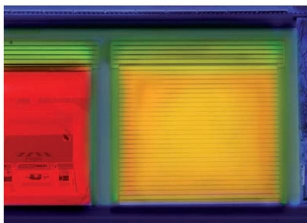
Esta imagen térmica de una puerta enrollable convencional muestra claramente la pérdida de calor hacia el exterior.
