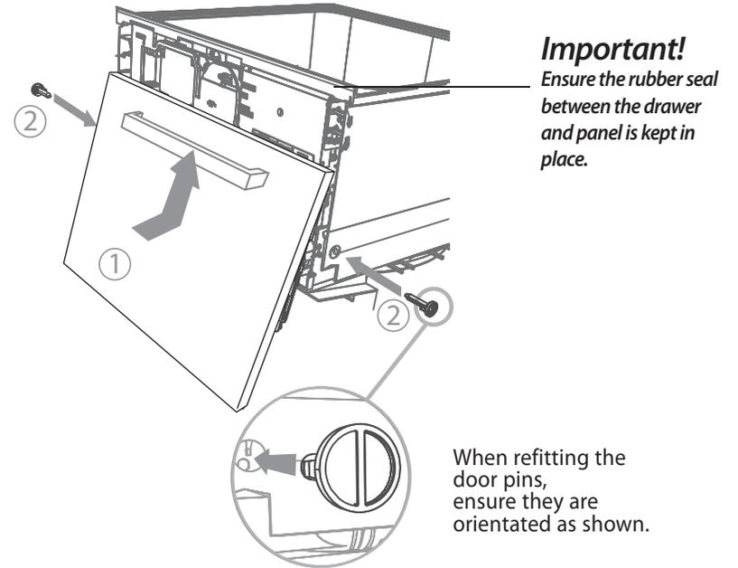
**(20a) ADJUST PANEL HEIGHT TO ALIGN THE CABINETRY GAPS**
