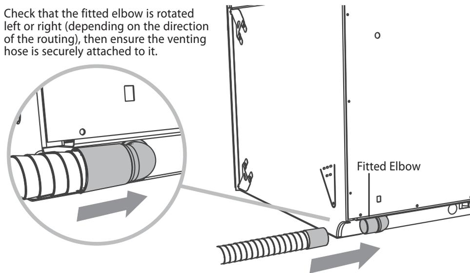
**12a) PULL THROUGH HOSES & MOVE INTO THE CAVITY**
