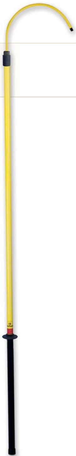
Pértigas de salvamento de un solo tramo fabricada en tubo de poliéster y fibra de vidrio de Ø 32 mm dotada de obturaciones antihumedad en ambos extremos, guardamanos, empuñadura, contera, cabezal métrico M-10 y gancho de salvamento. Se utiliza para rescatar la víctima de la zona de peligro.
