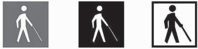
a) Branco sobre fundo azul b) Branco sobre fundo preto c) Preto sobre fundo branco Figura 26 — Símbolo internacional de pessoas com deficiência visual
