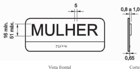
Figura 54 — Sinalização táctil – Exemplo (Dimensões em milímetros)
