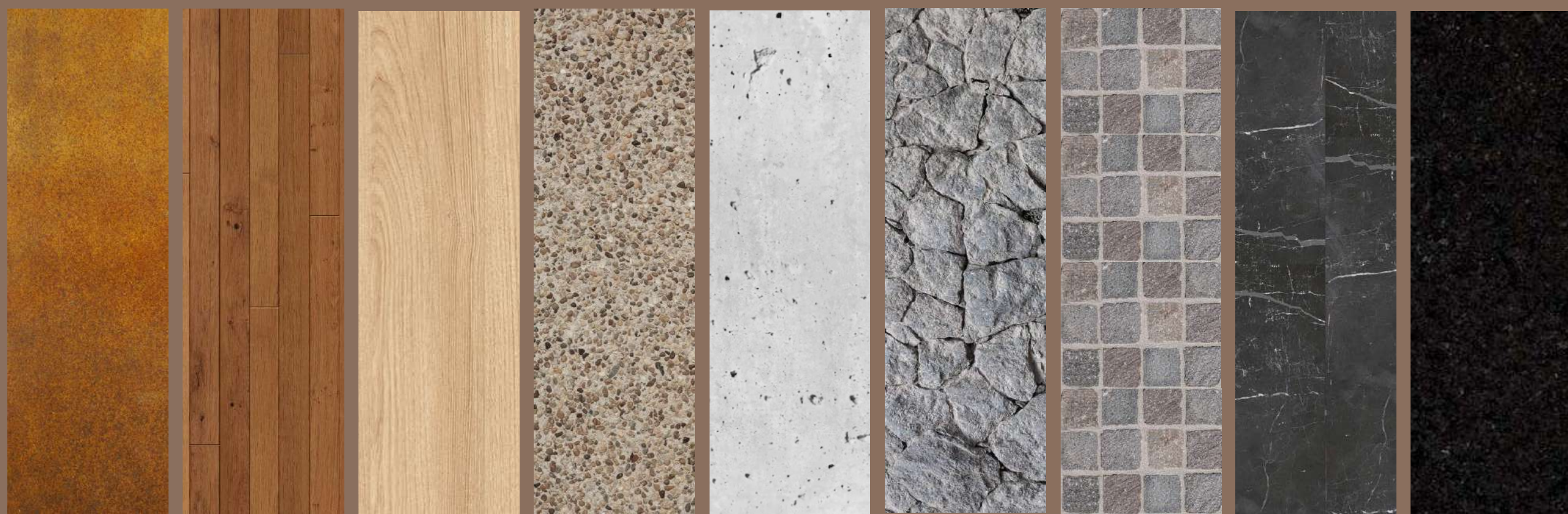
Perfilería acabado metálico bronce Pisos recámaras vinílico imitación madera Carpinterías melamina rosa morada Pisos exteriores concreto grano lavado Estructura en concreto acabado aparente liso Muros exteriores piedra gris Pisos exteriores porfido gris Pisos interiores porcelanato gris oscuro Cubiertas cocina granito negro galaxy
