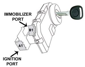
STEP 1. UNPLUG VEHICLE SIDE IGNITION PLUG > PLUG INTO VS4 > PLUG IN VS3 TO IGNITION PORT CONNECTOR
