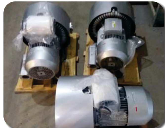
Compressores Radias Sopradores
