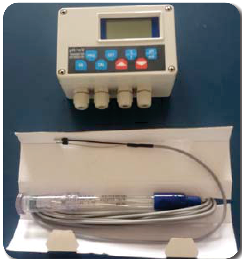
Controlador automático de pH com eletrodo
