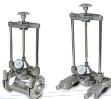
Máquina para pegar silletas de termofusión a
