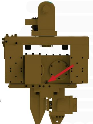
ABOVE IS THE SIGHT GLASS LOCATED ON THE BOTTOM OF THE GEARBOX.
