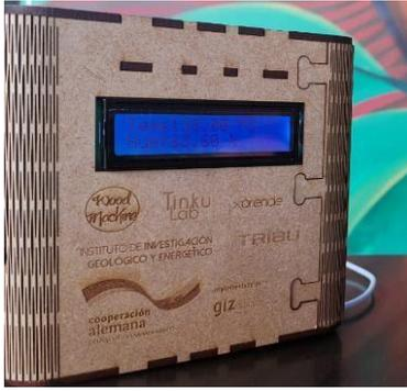
Finalmente se decidió realizar el prototipo con un diseño adaptado al hardware en Madera MDF de 2.8 mm con el proveedor Wood Machine y el fablab de Yachay, se decidió este material pues junto con el diseño se logra proteger el diseño del circuito, dispone de rejillas de ventilación y protege al sensor del polvo, y fluidos.
