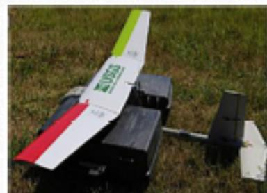
Están constituidos por un cuerpo principal, alas, hélice y motor, tienen mayor autonomía y velocidad, pero requieren de un entrenamiento específico y una pista de aterrizaje. Se utilizan sobre todo para control de fronteras y cartografía. Ejemplos: RQ-4 Global Hawk, Bayraktar TB2, CH-4.
