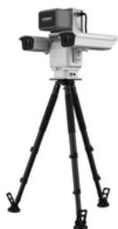
Utilizan imágenes de alta resolución y detección térmica para identificar y rastrear visualmente los drones.
