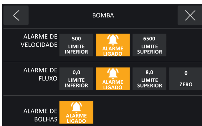
Figura 18 Configuração do alarme de fluxo, bolhas e velocidade
