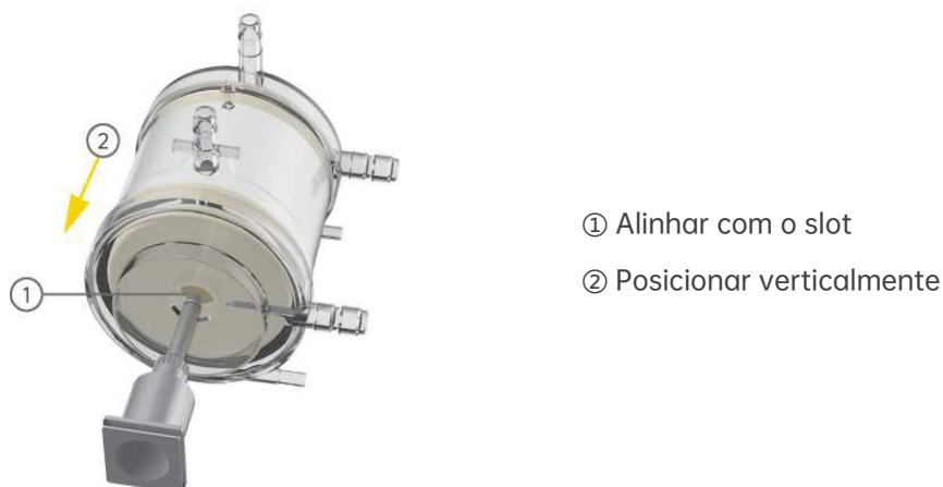
Figura 31 Instalação do oxigenador de membrana descartável
