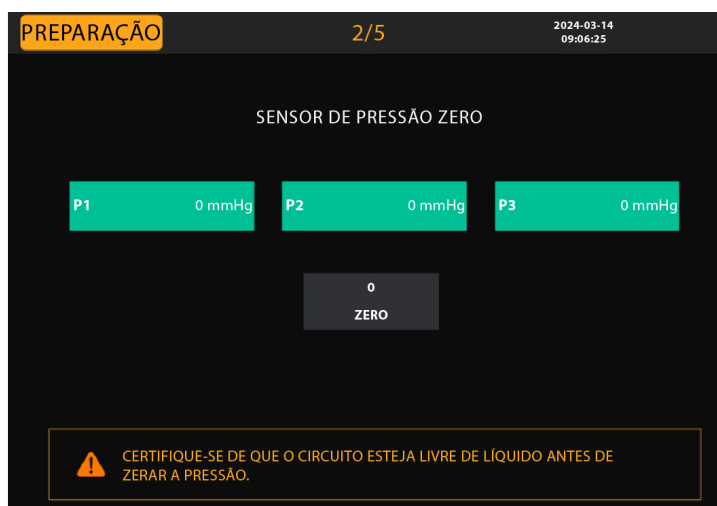
Figura 38 Zerar o sensor de pressão para a pressão atmosférica
