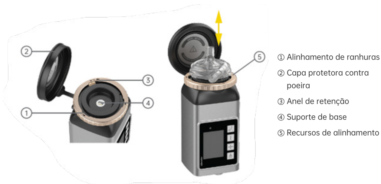
Figura 32 Recursos do acionador da bomba e recursos de alinhamento no cabeçote da bomba centrífuga descartável
