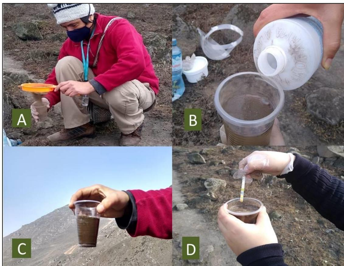
**Figura 4.** A) suelo tamizado, B) adición de agua destilada, C) agitación y sedimentación, y D) medición.
