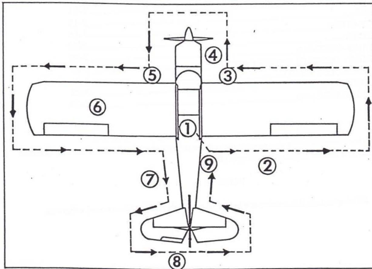
FIGURE 3 - 1 PREFLIGHT INSPECTION
