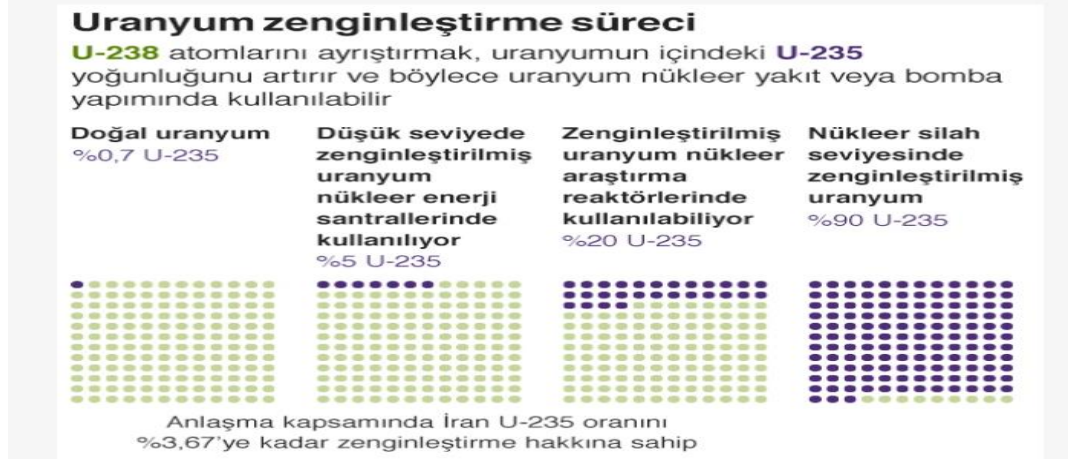
Şekil 2. Uranyum Zenginleştirme Süreçleri
