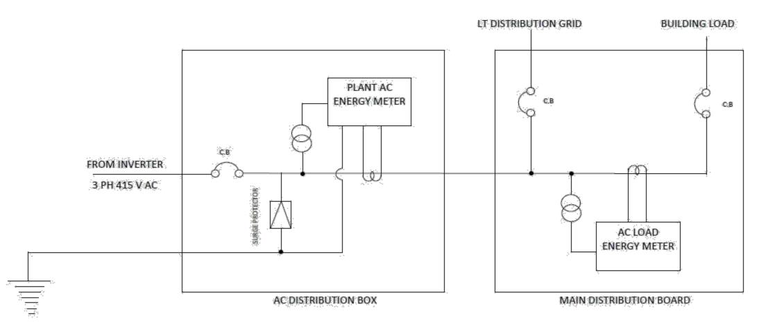
LT DISTRIBUTION GRID SUPPLY SCHEMATIC DIAGRAM
