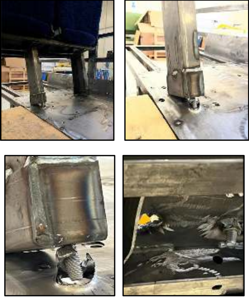
Şekil 3.17. Testte ayak bağlantılarında meydana gelen olumsuzlukların görünümü
