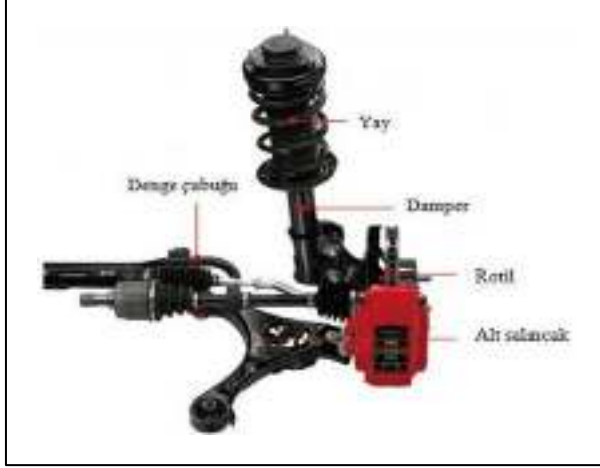
Şekil 7. MacPherson süspansiyon sistemi (Putgül ve Altıparmak, 2016)
