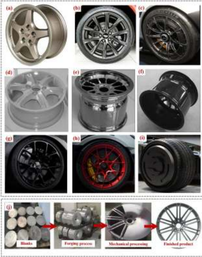
Şekil 16. Jantta Mg alaşımlarının geliştirilmesi ve uygulanması: (a) Chevrolet Corvette için Mg alaşım jant; (b) Cadillac CT4-V dövme Mg jant; (c) Biyonomik tasarıma sahip AMG Project One 9 kollu Mg dövme jantlar; (d) İçi boş kütük ekstrüde Mg alaşım jant: (14×6) J; (e) İçi boş kütük ekstrüde Mg alaşım jant: (13×10) J; (f) İçi boş kütük ekstrüde Mg alaşım jant: (13×8) J; (g) Bugatti Chiron Super Sport 300+Mg jant; (h) Porsche 911 GT3 RS Mg dövme jant; (i) Bandit9 elektrikli yarış Mg jant; (j) Dingxin Magnezyum Teknolojisi Şirketi'nden Mg alaşım otomobil jantı ileri ve geri ekstrüzyon şekillendirme teknolojisi süreci (Liu, 2023).
