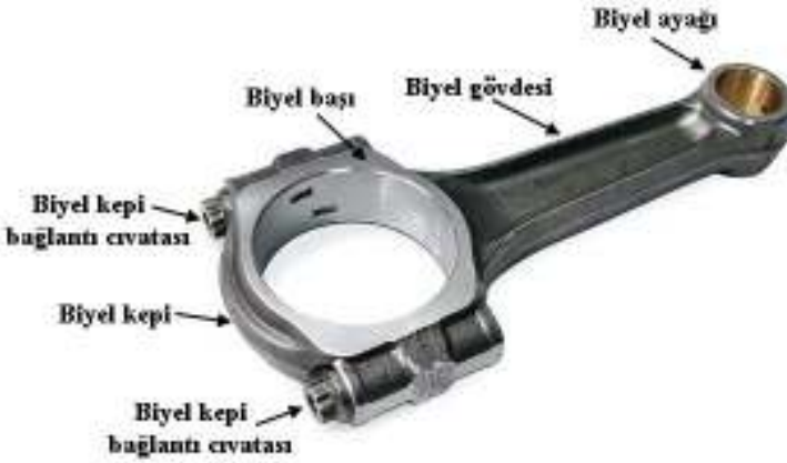
Şekil 1. Geleneksel biyel kolunu (piston kolunu) oluşturan kısımlar.
