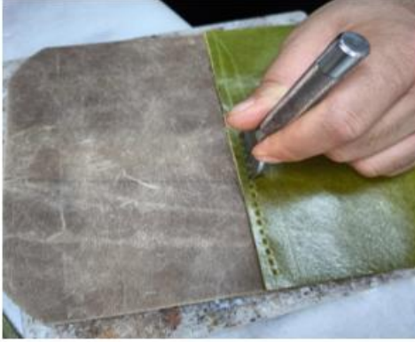
Resim 27. Kapağı punch ile delme
