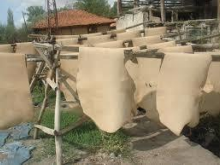
Resim 9. Vaketa deri güneşte kurutma
