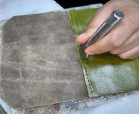
Resim 27. Kapağı punch ile delme
