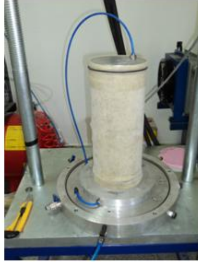
Şekil 8. MAKU-TRX deney cihazı ve numunenin cihazına yerleştirilmesi
