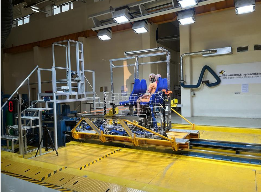
Şekil 3.5. Dinamik Test Düzenegi
