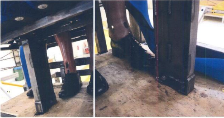
Şekil 3.32. Test öncesi koltuk bağlantı detayları
