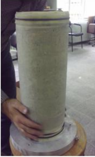
Şekil 8. MAKU-TRX deney cihazı ve numunenin cihazına yerleştirilmesi
