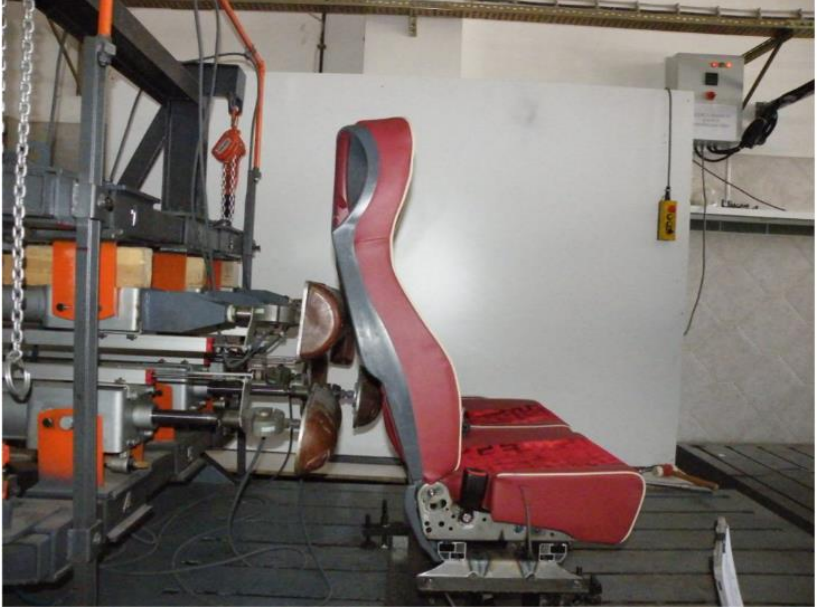
Şekil 3.6. Statik Test Düzenegi
