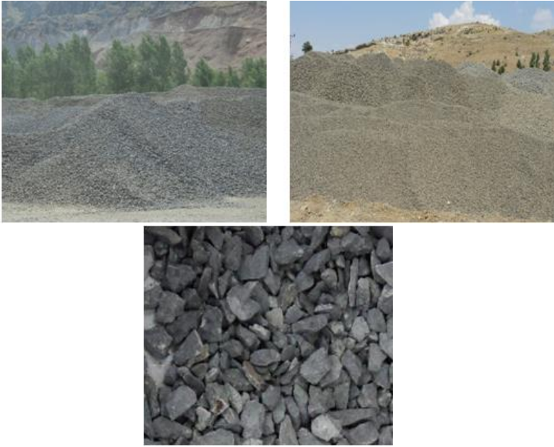
Şekil 4. Konkasörde kırılmış bazalt agregaları
