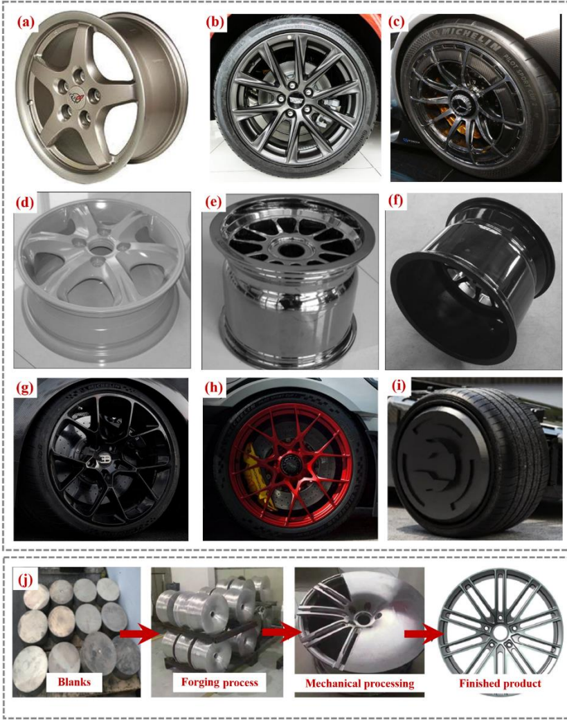
Şekil 16. Jantta Mg alaşımının geliştirilmesi ve uygulanması: (a) Chevrolet Corvette için Mg alaşım jant; (b) Cadillac CT4-V dövme Mg jant; (c) Biyotik tasarıma sahip AMG Project One 9 kollu Mg dövme jantlar; (d) İçi boş kütük ekstrüde Mg alaşım jant: (14×6) J; (e) İçi boş kütük ekstrüde Mg alaşım jant: (13×10) J; (f) İçi boş kütük ekstrüde Mg alaşım jant: (13×8) J; (g) Bugatti Chiron Super Sport 300+Mg jant; (h) Porsche 911 GT3 RS Mg dövme jant; (i) Bandit9 elektrikli yarış Mg jant; (j) Dingxin Magnezyum Teknolojisi Şirketi'nden Mg alaşım otomobil jantı ileri ve geri ekstrüzyon şekillendirme teknolojisi süreci (Liu, 2023).
