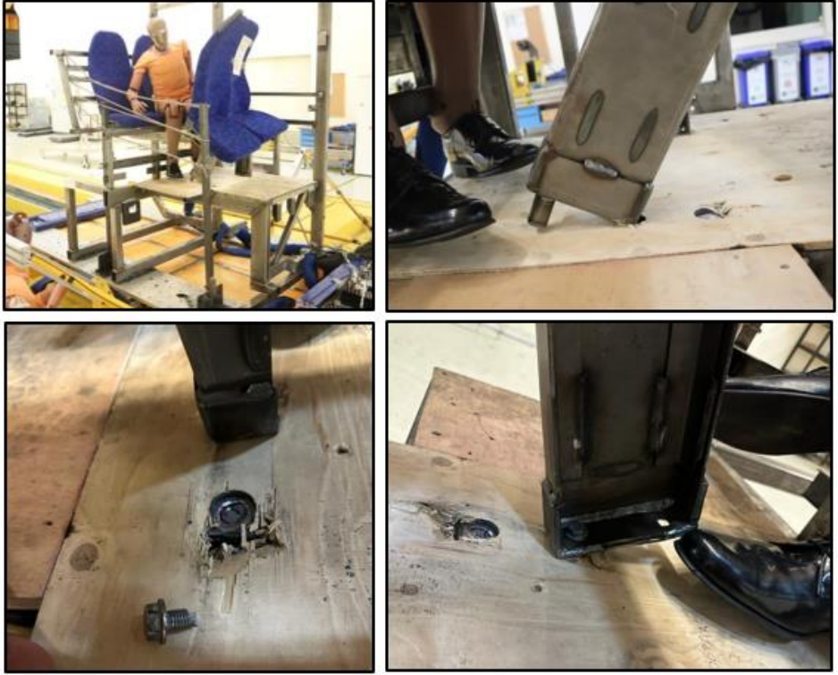
Şekil 3.33. 2.Mock-Up testinde ayak bağlantılarında meydana gelen olumsuzlukların görünümü
