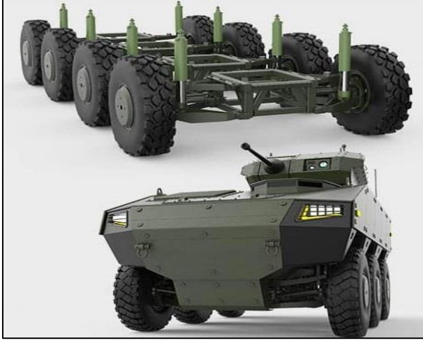
Şekil 11. Hidro-pnömatik süspansiyon sistemi (Kocakulak ve arkadaşları, 2019)
