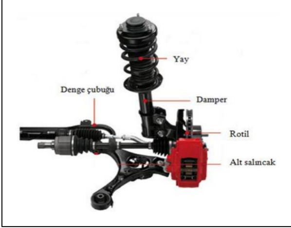
Şekil 7. MacPherson süspansiyon sistemi (Putgül ve Altıparmak, 2016)
