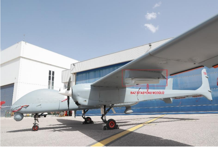
Şekil 11. AKSUNGUR İHA üzerine entegre edilen sivil İHA baz istasyonu modülü
