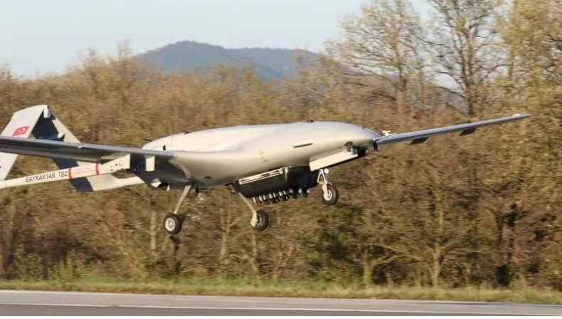
Şekil 4. Baykar Hızlı Haritalama Podu entegreli Bayraktar TB2 [5]
