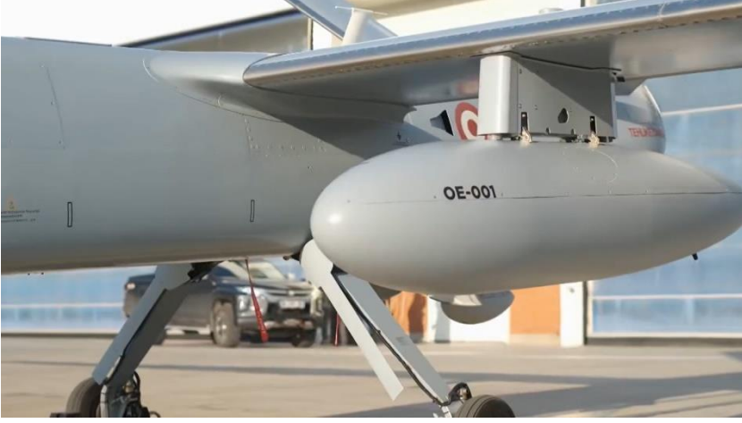
Şekil 10. ANKA İHA üzerine entegre edilen ULAK 4.5G baz istasyonu [12]
