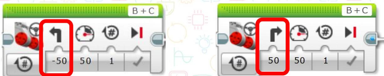
Рис.5. Реализация поворота первого типа при помощи блока «Рулевое управление».
