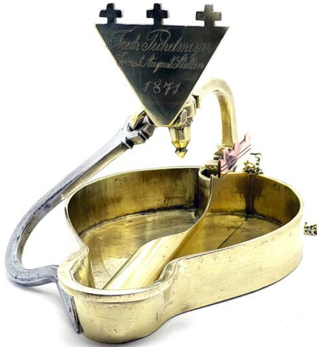
Abb. 8: Beispiel einer Harzer Ehrenlampe: Messingnes Unschlitt-Grubenlicht des Gedinghäuers Friedrich Pichelmeyer aus Hahnenklee, das ihm als einem von 18 Bergleuten anlässlich der Fertigstellung des Flügelortes Zellerfeld-Bockswiese des Ernst-August-Stollens im Jahr 1871 verliehen wurde. Gegossene Lampenschale, Eisenhaken, Kreuzschild ohne Bohrungen mit Gravur des Namens »Friedr[ich]. Pichelmeyer«, »Ernst August Stollen« und der Jahreszahl »1871«. Herstellerkennzeichnung des Clausthaler Schlossermeisters August Knodell seitlich am Bügelfuß und am Schalenboden. Die Lampen der 1871er Serie sind weitgehend baugleich mit den insgesamt 85 zur Eröffnung der Hauptstollenlinie des Ernst-August-Stollens im Jahr 1864 ebenfalls von Knodell gefertigten Ehrenlampen. (Privatsammlung, Foto: Hartwig Büttner)
