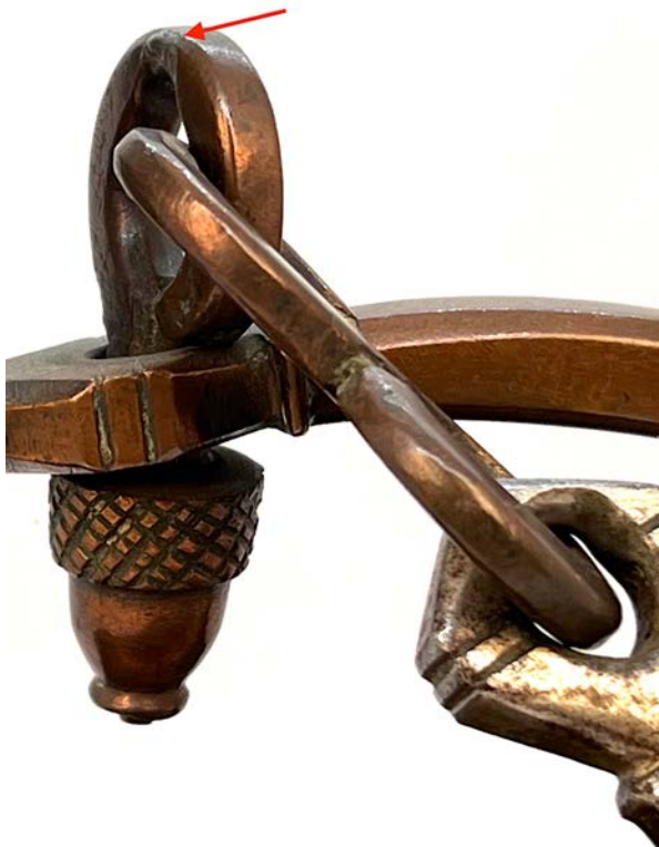
← Abb. 15: Wirbel der Unschlitt-Ehrenlampe aus Abb. 2 mit Drehlager in Eichelform, zeitgenössische Reparatur der Wirbelöse mit Blei-Zink-Lot an der ausgeriebenen Kontaktfläche mit dem achtförmigen Zwischenglied (Pfeilmarkierung). (Foto: Hartwig Büttner)
