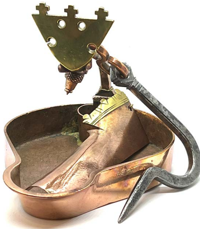
Abb. 10: Harzer Unschlitt-Grubenlicht aus Rotmessing mit Gelbmessing-Applikationen (Schildbeleg und Dochtblechverzierung) und Eisenhaken, Typ II nach Büttner und Spier (Schalenindex I,25), Clausthal um 1800, mit sehr ähnlichen Gestaltungsmerkmalen und gleichartiger Formsprache wie die etwas ältere Grubenlampe in Abb. 2. Lampenschale gegossen mit eingesetzter Bügeltülle, typische Bauform mit Kreuzschild, vier Schildbohrungen und Drehlager des Wirbels in stilisierter Eichelform. Ein Eisenhaken findet sich häufig an Harzer Unschlittlampen aus Buntmetall für den Arbeitseinsatz unter Tage. Der Grund ist darin zu finden, dass der Haken besonderen Belastungen ausgesetzt war, z. B. beim Eintreiben in Ausbauholz oder beim Aufhängen an Gesteinsvorsprüngen vor Ort, und Eisen bzw. Stahl härter und weniger leicht verformbar im Vergleich zu Messing ist. Es sind jedoch auch Harzer Unschlittlampen aus Messing bekannt, deren Haken ebenfalls aus Messing gefertigt sind, und die sehr wahrscheinlich überwiegend für repräsentative Zwecke hergestellt wurden. Solche vollkommen eisenfreie Grubenlichter wären jedoch auch als Markscheiderlampen geeignet gewesen (keine Ablenkung der Kompassnadel), doch konnte bisher keine identifizierte Unschlittlampe einem Markscheider zugeordnet werden. (Privatsammlung, Foto: Hartwig Büttner)
