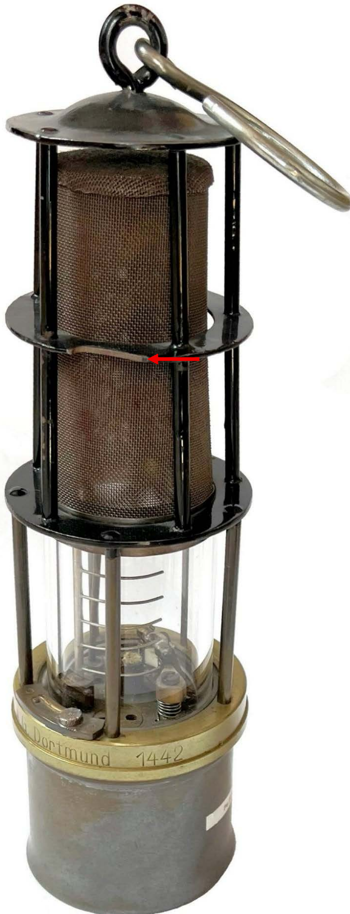
← Abb. 4: Typ 1442/01 mit Runddocht und Rulag-Trockenakkumulator als Fern-Gasanzeiger ohne Schutzmantel. An den oberen Gestellstäben befindet sich der zusätzliche Zwischenring mit Einkerbung (Pfeilmarkierung). (Sammlung Hans-W. Penker, Foto: Martin Zürn)
