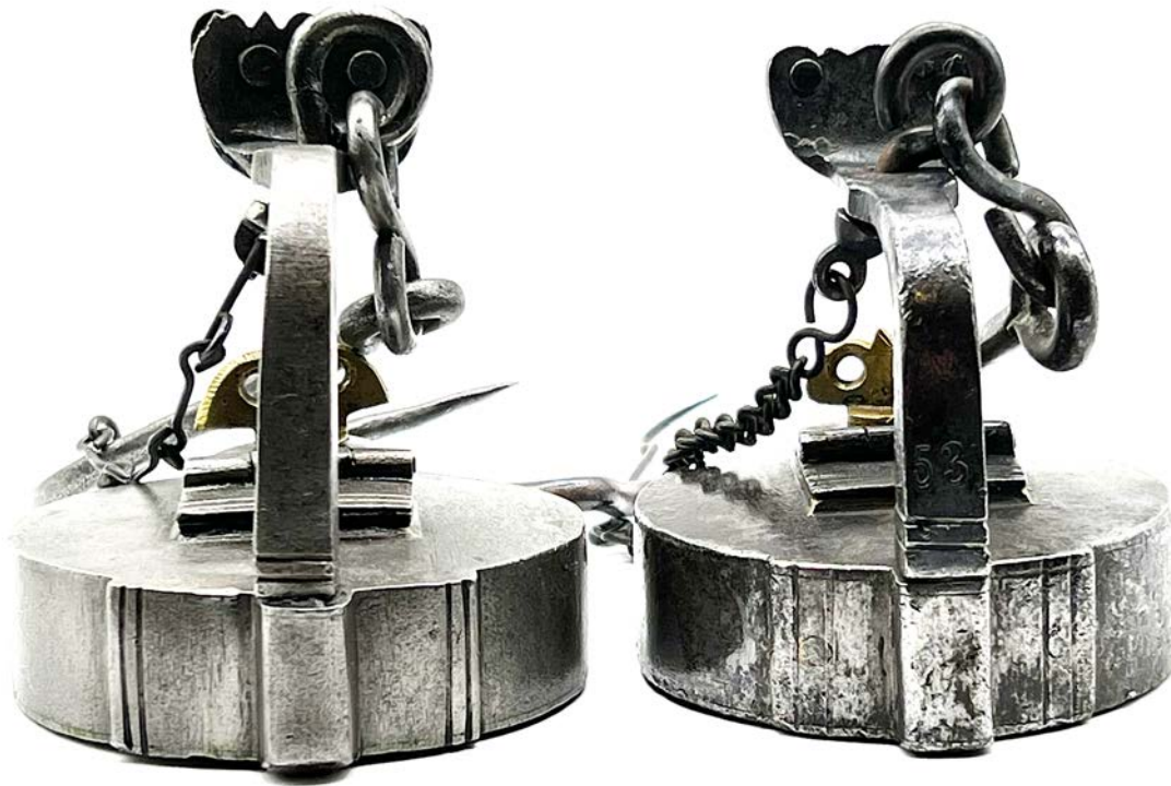
Abb. 10: Rückansichten der Schachtlampe von Reusch (links) und von vom Hofe (rechts) mit eingeschlagener Typennummer »53« an der Bügelrückseite. Dass vom Hofe versuchte, die Reusch-Schachtlampe so detailgetreu wie möglich zu kopieren, zeigt sich u. a. auch daran, dass selbst die senkrechten und waagerechten Zierlinien an der Bügelschelle und am unteren Bügelabschnitt vorbildgerecht eingefeilt wurden. (Privatsammlung, Foto: Hartwig Büttner)
