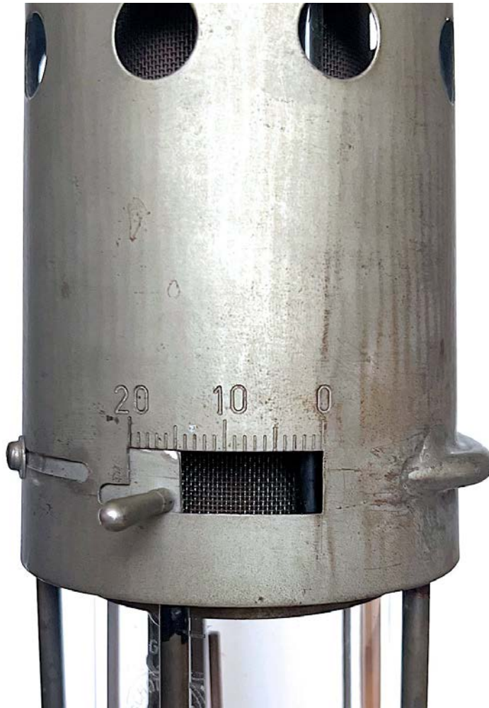
Abb. 8: Das verschließbare Schiebefenster im Schutzmantel mit einer Skala zum Verdünnen oder Konzentrieren der zugeführten Wetter. (Privatsammlung, Foto: Martin Zürn)
