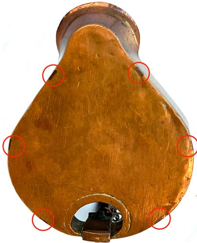
Abb. 11: Ansicht des Schalenbodens der Lampe aus Abb. 2: Erkennbar ist an der Hinterseite die Umbördelung der eingesetzten und verlöteten Bügeltülle. Die sechs nach unten überstehenden Laschen der Schalenwandung, die in passgenaue Schlitzte des Schalenbodens eingreifen (Lasche-Schlitz-Verbindung) sind deutlich sichtbar (Kreismarkierungen). Aufgrund der geringen Spaltbildung zwischen Schalenwand und Schalenboden durch das Zusammenfügen der beiden Bauteile in Lasche-Schlitz-Technik vor dem Verlöten findet sich kaum übergelaufenes Messinglot am Schalenboden. (Foto: Hartwig Büttner)
