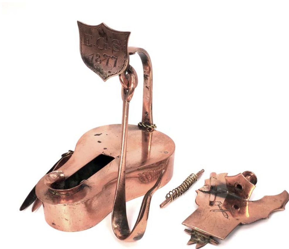
Abb. 11: Froschlampe aus Abb. 9 mit demontiertem Verschlusschieber. (Privatsammlung, Foto: Hartwig Büttner)
