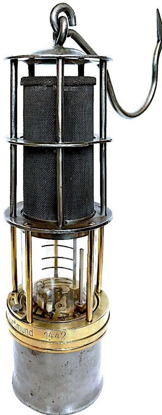
Abb. 9: Zum Fern-Gasanzeiger umgebaute CEAG-Sicherheitslampe Typ 1442/05 mit wiederaufladbarem Akku. (Privatsammlung, Foto M. Zürn)
