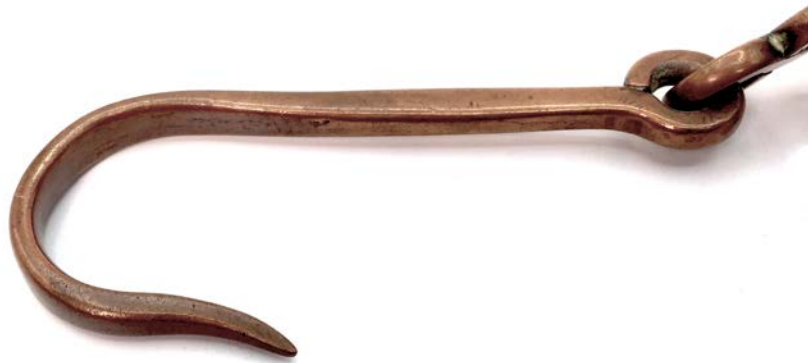
Abb. 6: Haken der Lampe von Göbl, anzusprechen als typischer einfach gekröpfter Příbramer Haken. (Privatsammlung, Foto: Hartwig Büttner)
