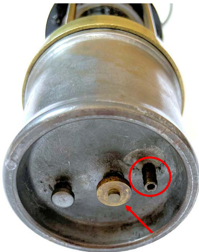
← Abb. 6: Unter dem Fern-Gasanzeiger das Röhrchen für den Schlauchanschluss (Kreismarkierung). Auffällig ist, dass die Dochtstellschraube (Pfeilmarkierung) bei den wenigen bekannten Originalausführungen bisher stets eine ungewöhnlich große Form aufweist. (Sammlung Hans-W. Penker, Foto: Martin Zürn)
