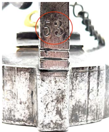
← Abb. 11: Eingeschlagene Typenbezeichnung »53« (Kreismarkierung) am unteren Bügelabschnitt der Bergmannslampe von Carl vom Hofe. (Privatsammlung, Foto: Hartwig Büttner)
