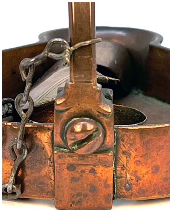
Abb. 14 →: Rückansicht des Bügelfußes der Lampe aus Abb. 2: gekahlter und getreppter Übergang des Bügelfußes zum Bügelbogen, Rundkopf-Schlitzschraube zum Verklemmen des Bügelfußes in der Bügeltülle. (Foto: Hartwig Büttner)
