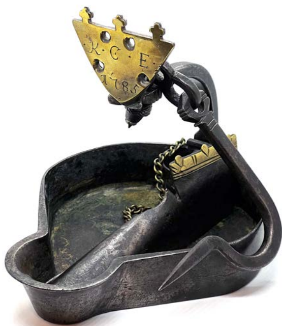
← Abb. 4: Eiserne Harzer Unschlitt-Grubenlampe (Typ II nach Büttner und Spier) mit gelöteter Schale, Clausthal, 1785, gefahrene Arbeitslampe. Kreuzschild mit vier Bohrungen sowie gravierten Besitzerinitialen (»K · C · E«) und Jahreszahl (»1785«), Schalenindex 1,25. Diese Bauform ist mit leichten Abwandlungen – insbesondere mit größerem Längen-Breiten-Verhältnis von Schalenlänge zu Schalenbreite (Typ III) – noch bis in die ersten Jahre des 20. Jahrhunderts im Harzer Bergbau als Beamtenlampe nachweisbar.
