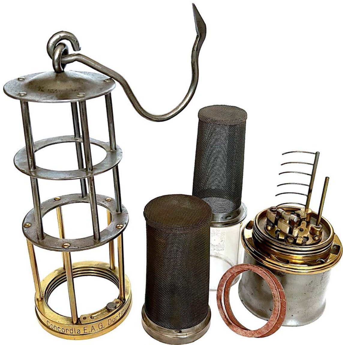
Abb. 10: Geöffnete Fälschung eines Fern-Gasanzeigers mit Messingröhrchen und Aureolenkamm. (Privatsammlung, Foto M. Zürn)
