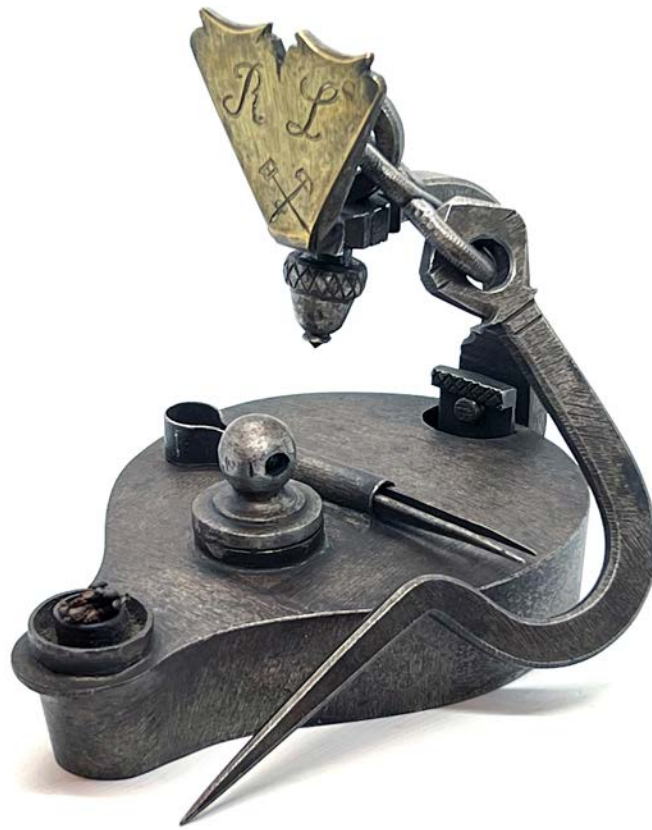
Abb. 7: Letzte Bauform der Harzer Rüböl-Grubenlampen mit Schraubverschluss (Typ V nach Büttner und Spier), wie sie um 1870 aufkam und bis etwa 1919 verwendet wurde. Mannschaftslampe aus Bad Grund, um 1900. Neben der Änderung des Verschlusses der Öleinfüllöffnung (Schraubverschluss mit Luftführung als technische Verbesserung) wurde auch die Gestaltung des Schildes bei den Harzer Rüböllampen nach der Mitte des 19. Jahrhunderts modifiziert, die symbolbeladenen Kreuze und Schildbohrungen entfielen, der Schildoberrand wurde bei diesen Lampen gewellt, gebogen oder gezackt ausgeführt. Die Gestaltung und Formsprache der Harzer Unschlittlampen folgte allerdings noch bis zum Beginn des 20. Jahrhunderts überwiegend den traditionellen Mustern. (Privatsammlung, Foto: Hartwig Büttner)
