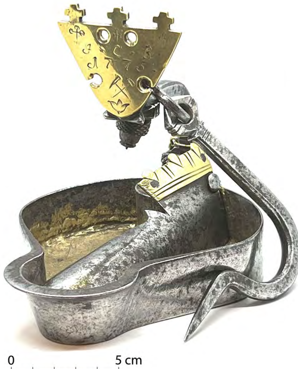
Abb. 32: Originäres Harzer Unschlitt-Grubenlicht aus Clausthal, datiert 1775. Abgesehen von der Gesamtgröße, Flankenrundung der Lampenschale und einem größeren Bügelradius folgen Formgebung und Detailgestaltung den ausgebildeten Spätformen sächsischer Grubenlampen für Unschlittbrand mit Kreuzschild, vier Öffnungen im Schild und stilisierter Eichel als Drehlager des Wirbels, etc. (vgl. Abb. 31). Neben der Jahreszahl, Besitzerinitialen (»J * C * B *«) und Schlägel und Eisen sind auf dem Schild unterhalb der am oberen Rand ausgearbeiteten Kreuze zusätzlich drei abgewandelte Apfel- oder Ballenkreuze graviert, an der Spitze unten ein Dreiblatt (zusätzliche Symbole der Dreifaltigkeit Gottes). (Privatsammlung, Foto: Hartwig Büttner)
