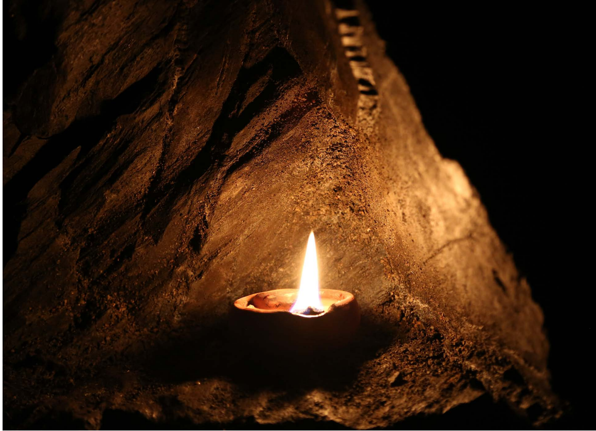
Abb. 18: Tonschalenlampe (Funktionsreplikat) in einer Lampennische im Brennversuch unter Tage. Der Versuch verdeutlicht die geringe Lichtstärke der Lampenflamme der mit Unschlitt betriebenen Tonschalenlampe bei der ortsfesten Beleuchtung. (Befahrung und Foto: Hartwig Büttner)
