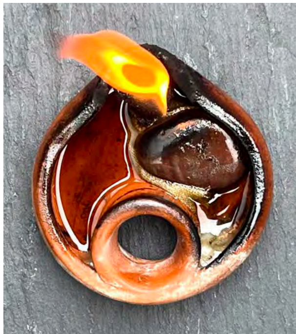
Abb. 11: Brennversuch mit Leinendocht und eingelegtem flachen Flusskiesel als Dochtniederhalter. Der das freie Dochtende bedeckende flache Stein verhindert einen Übergriff der Lampenflamme auf die gesamte Dochtlänge bei sinkendem Brennstoffspiegel. Zudem erweist sich das Fixieren des Brandendes (Knoten) durch den Kiesel bei der Fahrung als vorteilhaft, weil eine Dislokation des Knotens weitgehend verhindert wird. Anders als bei stationär betriebenen Lampen besteht die Gefahr der Lageveränderung des eingelegten Dochts bei stärkeren Bewegungen der Lampe, besonders wenn größere Teile des Unschlitts verflüssigt sind oder der Brennstoffspiegel gesunken ist. (Funktionsreplikat hergestellt von Dipl. Keramikerin Susanne Protzmann, Berlin, Foto: Hartwig Büttner)
