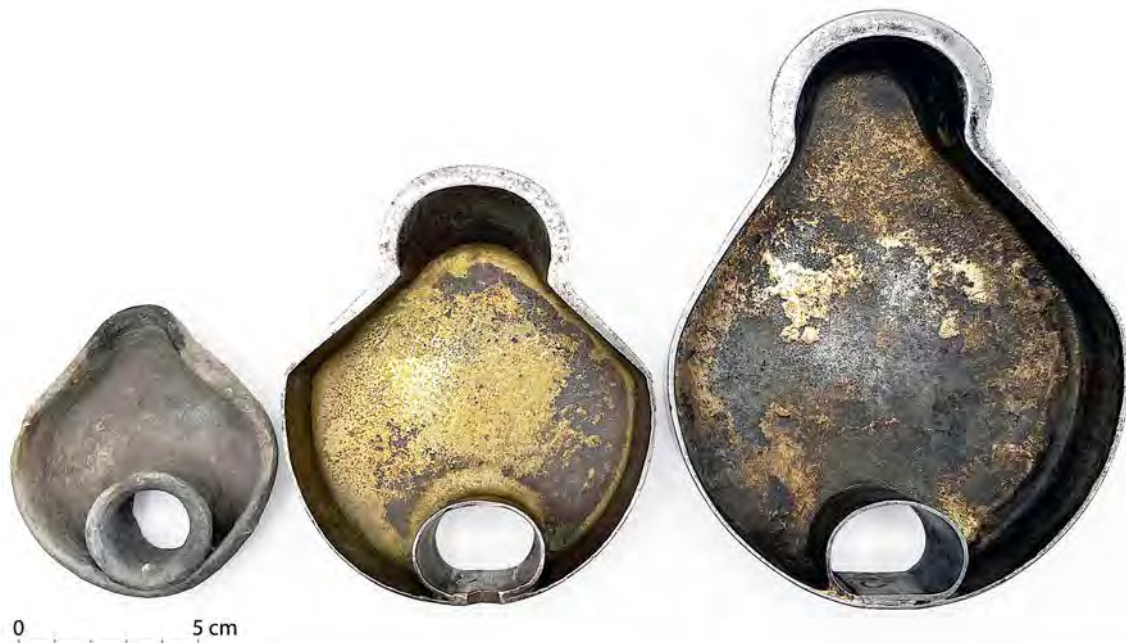
Abb. 25: Links Tonschalenlampe (Kuttenberg/Kutná Hora, 15. Jahrhundert), in der Mitte Schale einer sächsischen Unschlittlampe (um 1700), rechts Schale einer Harzer Unschlittlampe (um 1800); die Bügel der Lampen in der Mitte und rechts wurden für die Aufnahme entfernt. Deutlich erkennbar ist die Entwicklung der Schalen der metallenen Unschlitt-Grubenlampen aus den spätmittelalterlichen Tonschalenlampen. Die ursprüngliche Griffülle der Tonlampen wird bei den späteren metallenen Unschlittlampen für die Befestigung des überwölbenden Bügels genutzt. (vgl. Abb. 31) (Privatsammlung, Foto: Hartwig Büttner)
