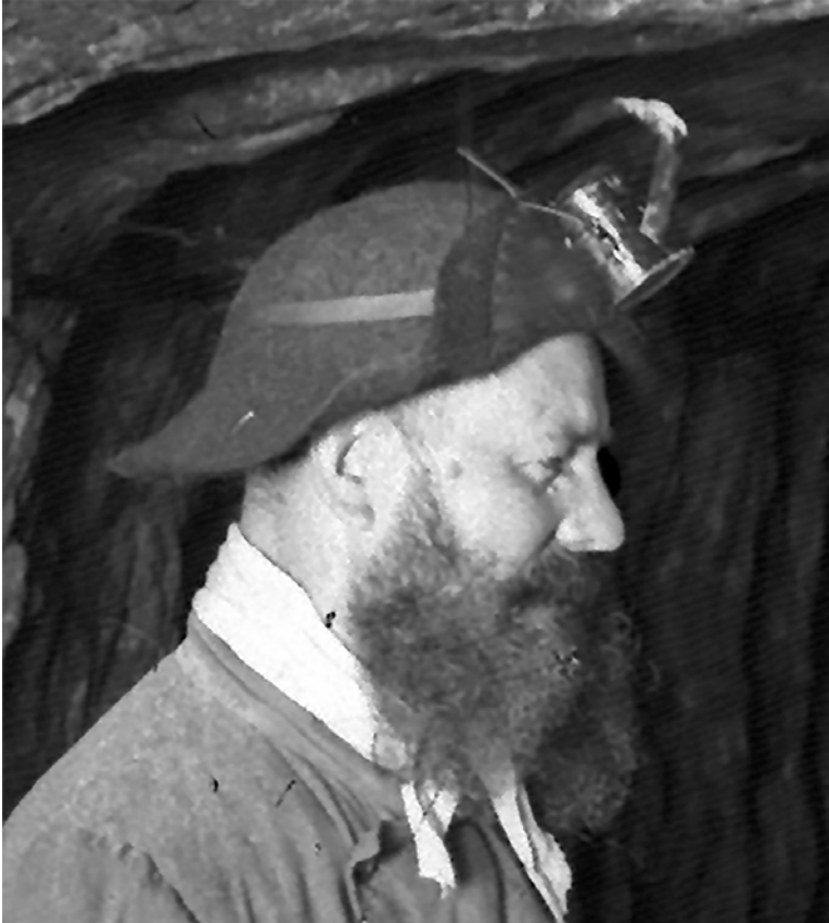
Abb. 5 | Ausschnitt-Vergrößerung aus Abb. 2. Hutschelle Mansfelder Bauart mit Tellerfuß, die an einem Schachthut mit hochgebogener vorderer Krempe mit Lederbesatz und Drahtstift befestigt ist
