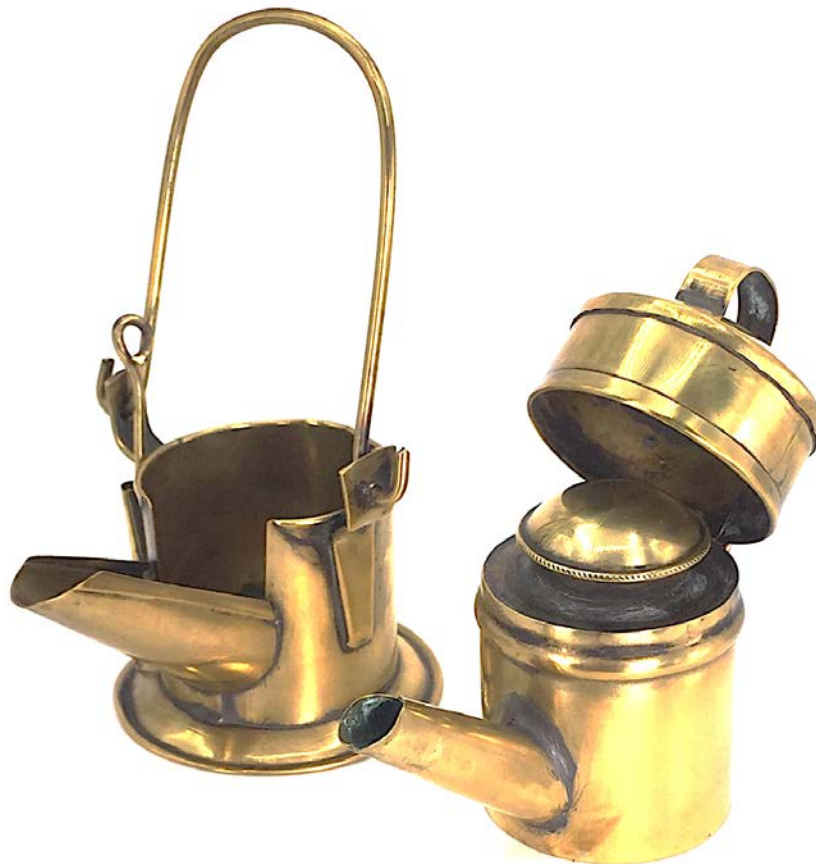
Abb. 7 | Messing-Hutschelle Mansfelder Bauart mit ausgestellttem Tellerfuß und aufgelöteter Handhabe am Verschlussdeckel, um 1890. Links Außentopf mit angesetztem Ölfang und in so genannte Attaschen eingehängtem Bügel; rechts eigentliche Lampe mit Schraubverschluss der Öleinfüllöffnung und zusätzlichem Klappdeckel mit aufgelöteter Handhabe, Foto: Dr. H. Büttner
