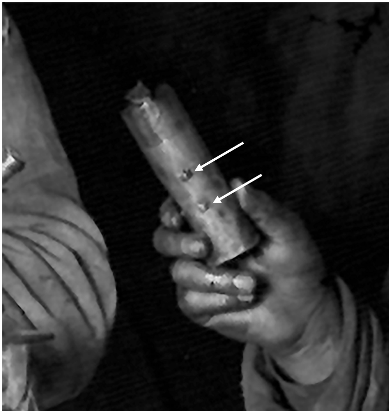
Abb. 10 | Ausschnitt-Vergrößerung aus Abb. 2. Es handelt sich bei dieser Lampe mit oben senkrecht ausgeführter Dochtstülle um eine typische Markscheiderlampe. Ein ursprünglich vorhanden gewesener seitlich angebrachter Handgriff wurde bei dieser Lampe offensichtlich entfernt oder ist verloren gegangen (Pfeilmarkierungen: Griffbefestigungen am Lampenkorpus)
