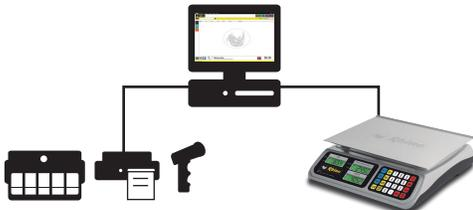
Conexión a PC para utilizar soluciones en Punto de Venta
