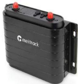
El MVT600 es uno de los más robustos y rastreadores GPS completos en el mercado. Este dispositivo tiene la capacidad de incluir accesorios adicionales como cámaras, sensores de combustible y temperatura, lectores RFID y más. Este modelo es el preferido de muchos vehículos de flotillas.
