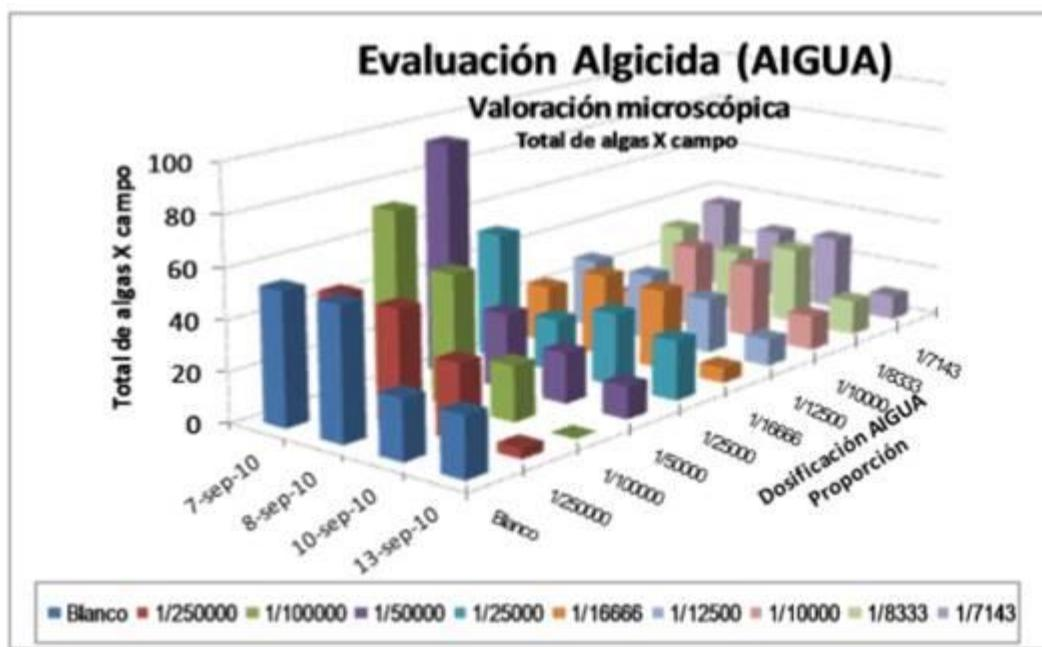
En esta primera, de acuerdo a los resultados que se especifican en el **Anexo No. III** se logra ver una diferencia ligeramente significativa a partir de una dosificación en proporción de una parte del producto AIGUA en 25,000 partes de agua con un contenido de algas importante a tratarse
