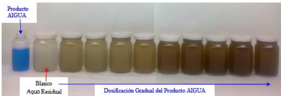
Con la capacidad de que mediante un tiempo de reposo estos pueden sedimentar y por lo tanto clarificar, como se muestra en la siguiente fotografía
