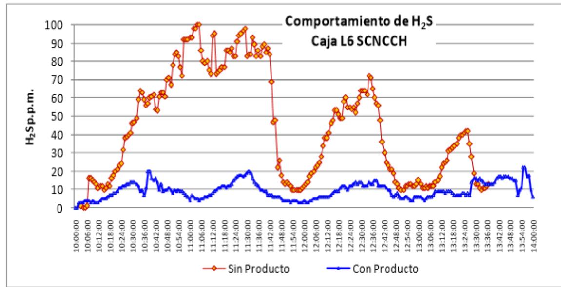
Este comportamiento permite visualizar el amortiguamiento que genera el efecto de la aplicación del producto AIGUA en cuanto a los incrementos relevantes en la concentración de H<sub>2</sub>S que se ven en un día previo, y que aún cuando no se logró mantener en este sitio los valores por debajo de los 10 ppm, esto obedece a que en este sitio las aguas provenientes del colector Miraflores se encuentran ya combinadas con tres aportaciones adicionales.
