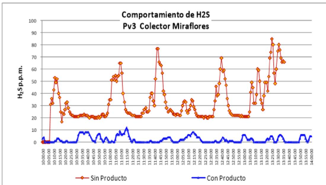
En la primer gráfica para el pozo de visita más próximo a la dosificación, se puede observar el efecto de la aplicación del producto AIGUA en la disminución de los valores de H<sub>2</sub>S, logrando que los valores permanecieran por debajo de las 10 ppm, en forma contrastante con el comportamiento de un día normal previo.
