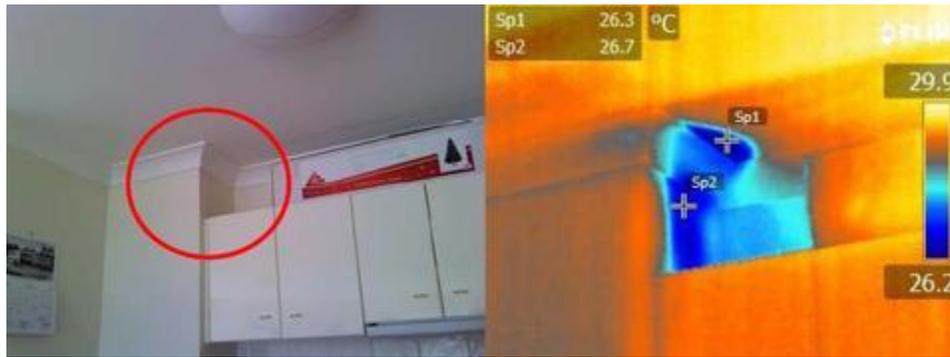
图 3：显示公寓厨房漏水的热图像（可能来自上方的邻居）。发现所有黑点都具有很高的水位，但壁上没有可见的污点。
