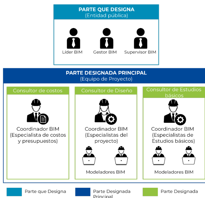
Figura 12 – Esquema organizacional de las partes involucradas y roles en el desarrollo de la fase de Ejecución (etapa de Elaboración del expediente técnico o documento equivalente) bajo el ámbito de aplicación de la Ley de Contrataciones del Estado (elaboración propia)
