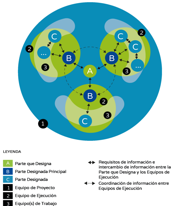
Figura 8 – Partes y equipos involucrados en el proceso de Gestión de la Información BIM (gráfico adaptado de la NTP ISO 19650-2:2021)
