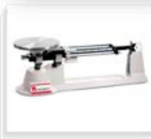
Balanza mecánica de triple brazo.
