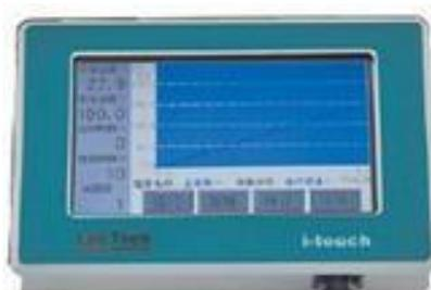
**TERMINAL DIGITAL** El Touch Terminal ofrece; a todos los usuarios del DigiBlock la posibilidad de programar y almacenar los métodos de digestión de muestras de forma programables en el disco duros interno.
