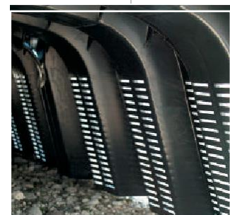
⑤ 底面と側壁の溝により、12.400cm 2 の浸透面が作成される
