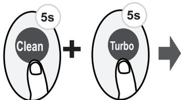
Appuyez simultanément sur le bouton Clean et le bouton Turbo pendant plus de 5 secondes pour activer la fonction de verrouillage. Tous les boutons ne répondront pas, sauf si vous appuyez à nouveau sur ces deux boutons pendant deux secondes pour désactiver le verrouillage.
