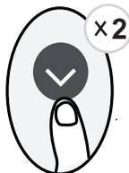
L'unité fonctionnera à une vitesse de ventilation élevée (avec le compresseur en marche) avec une température automatiquement réglée à 8 °C/46 °F.
