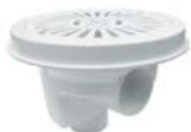
Fabricado en material ABS blanco. Salida lateral de 2" y salida inferior de 1 1/2". Salida inferior tapada con un semitroquelado, lo cual permite que se pueda abrir según necesidad. Caudal máx: 13 m³/h.
