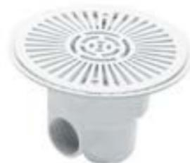
Salida inferior de 1 1/2" y lateral de 2". Construido totalmente en ABS color blanco. Salida lateral con posibilidad de instalación de un tapón para pruebas de estanqueidad. Salida inferior con tapón y posibilidad de montaje de válvula hidrostática (Cód. 00277) y tubo drenaje (Cód. 21581). Reja de aspiración Ø 250 mm. Caudal máx: 13 m³/h.
