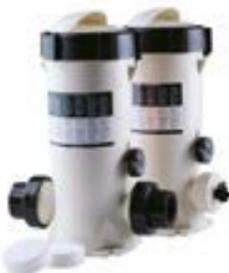
Dosificador de cloro y bromo. Fabricado en materiales plásticos inalterables (ABS). Capacidad aproximada de 3,5 kg de tabletas. Cierre con doble sistema de seguridad en la tapa. Válvulas de regulación de sencilla utilización. Para piscinas de hasta 60 m<sup>3</sup> con cloro y para piscinas de hasta 30 m<sup>3</sup> con bromo. Altura: 405 mm.
