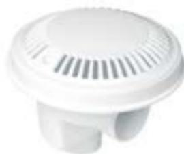
Fabricado en material ABS blanco. Salida lateral de 2" y salida inferior de 1 1/2". Salida inferior tapada con un semitroquelado, lo cual permite que se pueda abrir según necesidad. Posibilidad de montaje de tubo de drenaje (Cód. 21581). Caudal máx: 13 m³/h.
