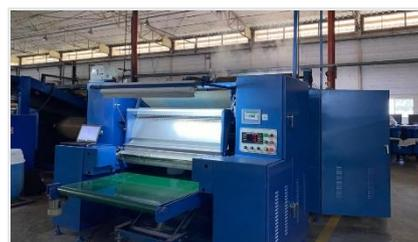
Recuperación máquina Compactadora de Tela para la industria Textil
