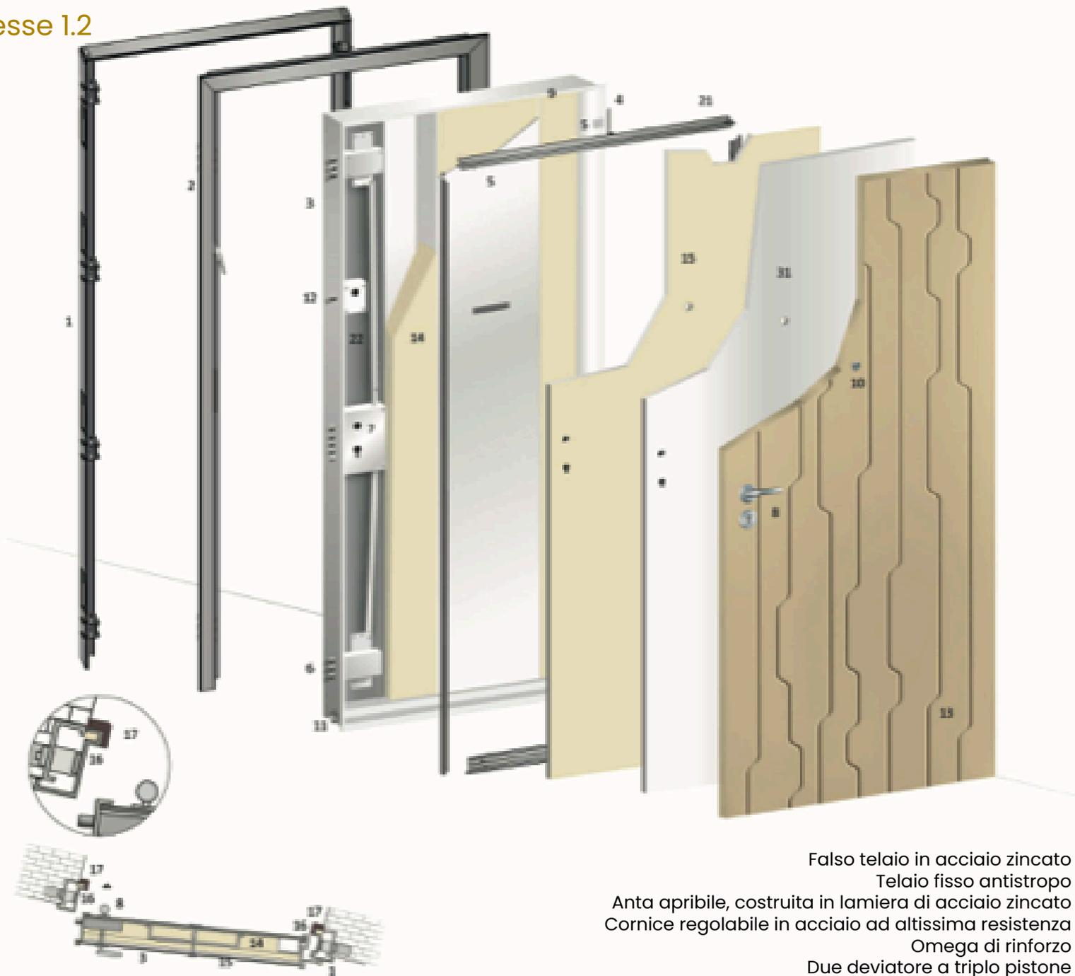
Serratura a cremagliera con cilindro europeo VIPER MOTTURA con 5 chiavi + 2 da cantiere
