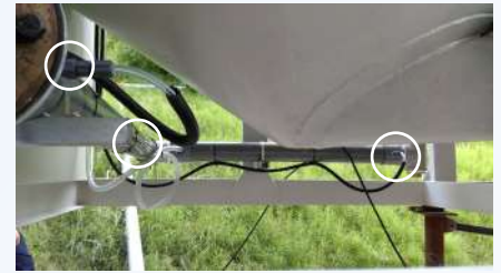
分隔的注藥入口 Separated Chemical Injection Point
