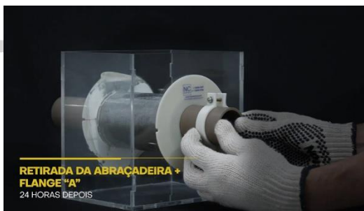
Figura 13 - retirada da abraçadeira e do flange “A”
