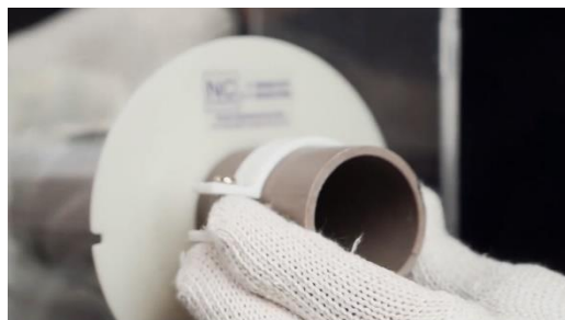
Figura 10 - posicionamento da abraçadeira na tubulação
