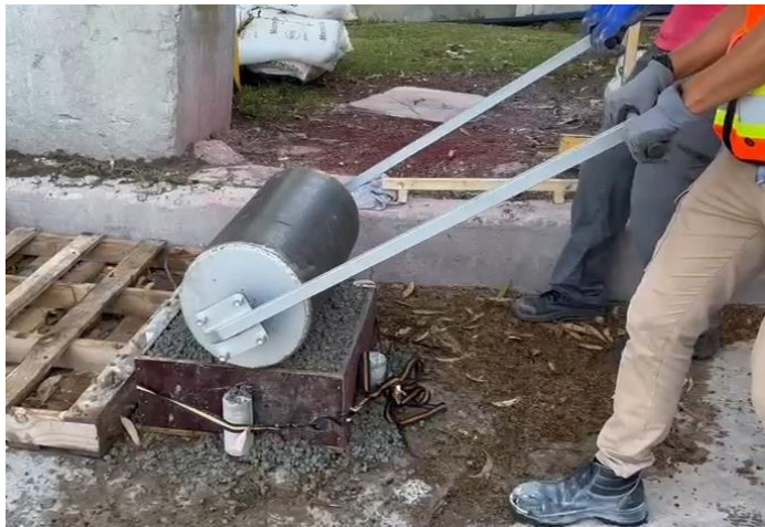
Rodillo de 60 cm de longitud con \Phi 30 cm y 100 kg/m
