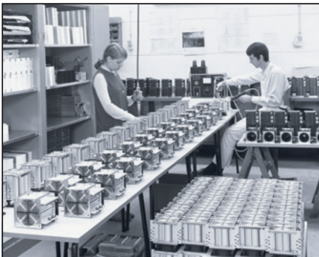
Montage von Lüfteraggregaten für TO-3 Bauelemente Mitte der 60er Jahre aus den Anfängen der Seifert electronic.
