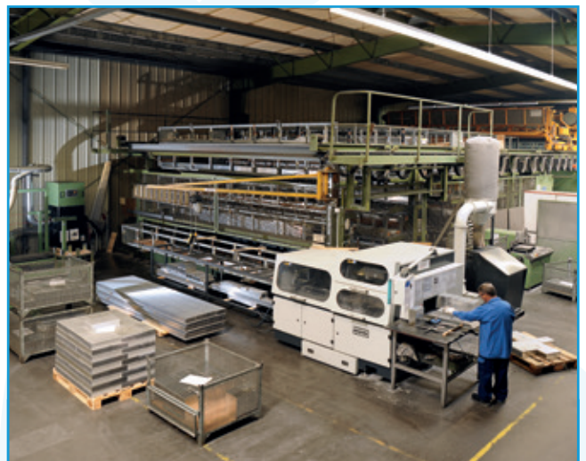
Ein rechnergesteuertes Containerlager bietet Lagerplatz für 250 Tonnen hochwertige Profilkühlkörper. Automatische Profilsägen und Bürstanlagen fertigen maßhaltige und gratfreie Kühlkörper.
