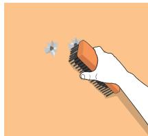
Elimina todas las partículas sueltas, restos de desmoldantes, partes mal adheridas, lechada y restos de pintura.
