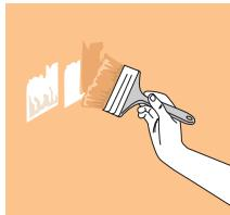
Una vez seco totalmente se puede lijar para darle acabado. Si no requiere lijar puede pintarlo inmediatamente después que haya secado superficialmente.
