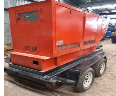
Generador de 100 KW diésel MQ Power capacidad 8 maquinas de soldar
