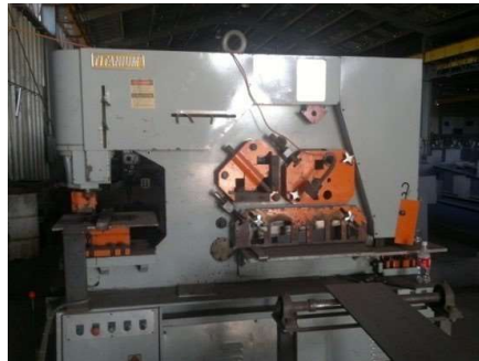
Iron Worke marca Titanium cap.80000 kg.
