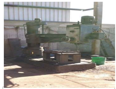
Taladro radial para perforar hasta 4 pulgadas de diámetro y 8 pulgadas de espesor.
