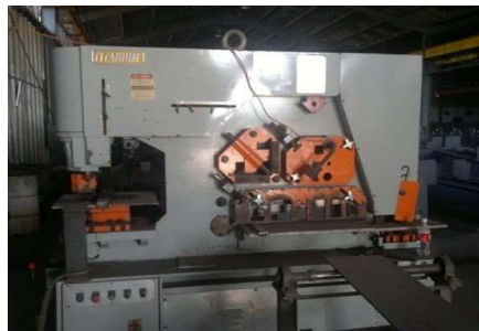
Iron Worke marca Titanium cap.80000 kg.
