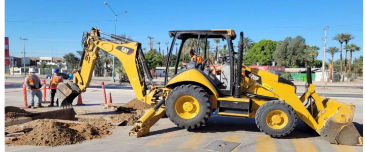
RETROEXCAVADORA CATERPILLAR 420 F Modelo 2015 / Accesorio para Martillo, 4 x 4
