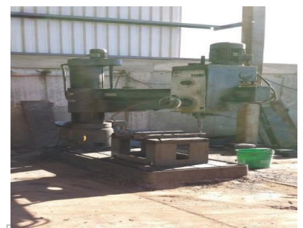
Taladro radial para perforar hasta 4 pulgadas de diámetro y 8 pulgadas de espesor.
