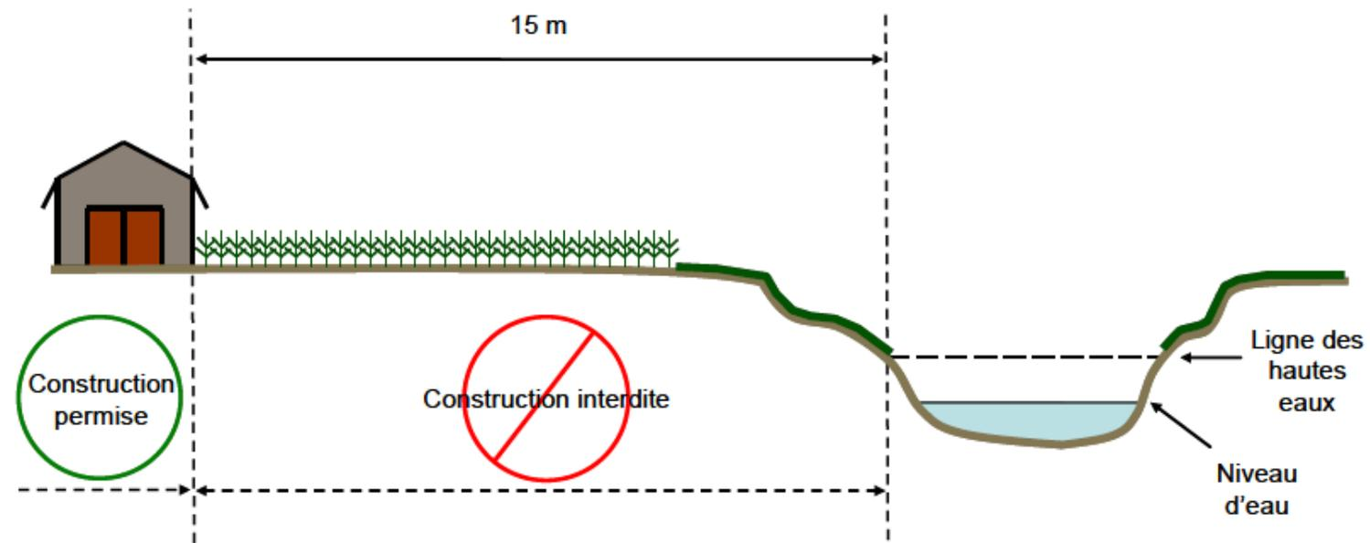
Figure 2 : Distance minimale à respecter pour la construction d'une installation d'élevage ou d'un ouvrage de stockage des déjections animales à proximité d'un cours d'eau ou d'un plan d'eau
