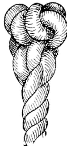
FIG. 116.—Wall knot (tucked).
